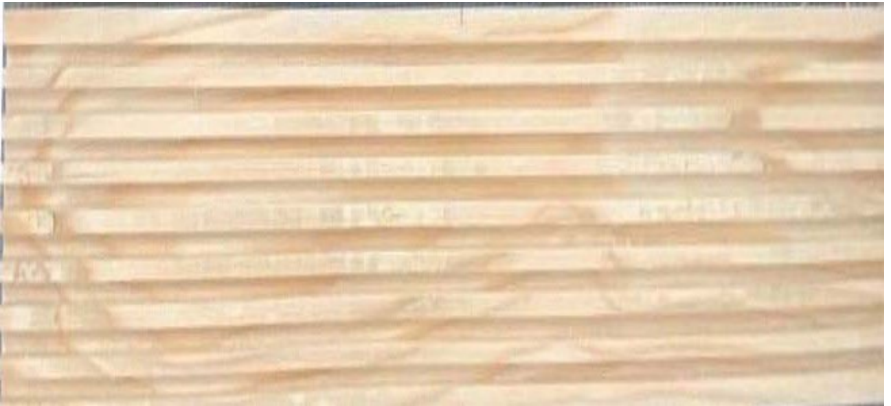
Рис. 2.2. Зразок підготовленої дерев'яної основи для приклеювання зразків кернів
