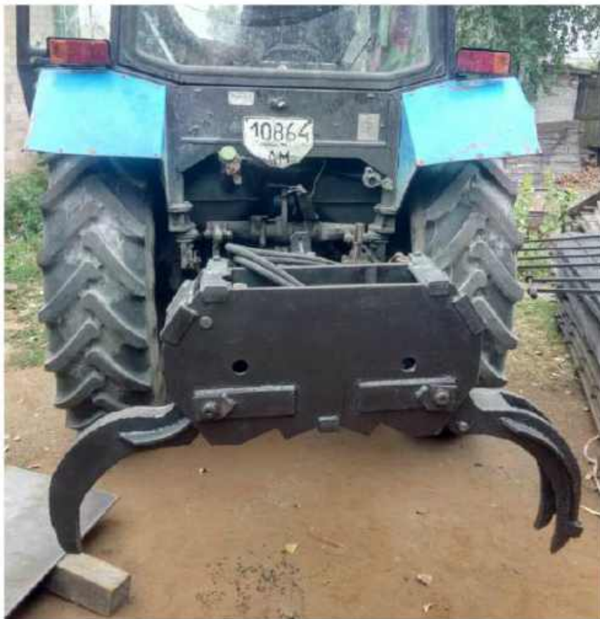
Рисунок 2.2 — Кліщовий захват малогабаритного колісного трелювального трактора
