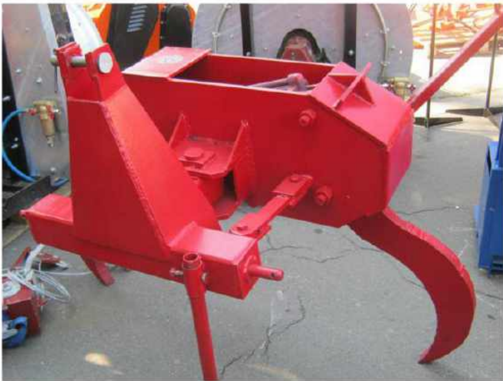
Рисунок 2.3 – Безчокерне трелювальне обладнання ПТБ-4,5М
