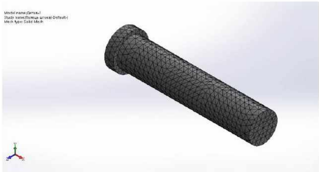
Рисунок 3.4 – Згенерована на поверхні з'єднувального пальця сітка напружень
