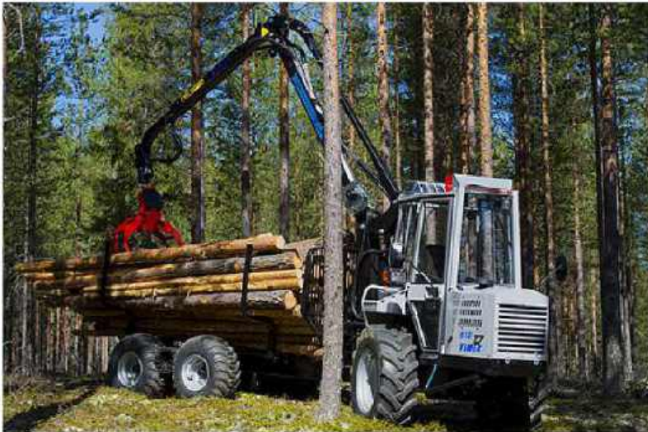
Рисунок 1.5 – Форвардер виробництва Vimek 610.4 (Швеція. Сайт компанії-виробника)
