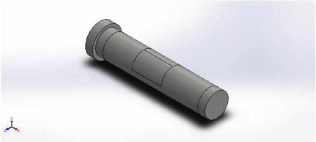
Рисунок 3.1 – Згенерована 3Д модель зєднувального пальця
