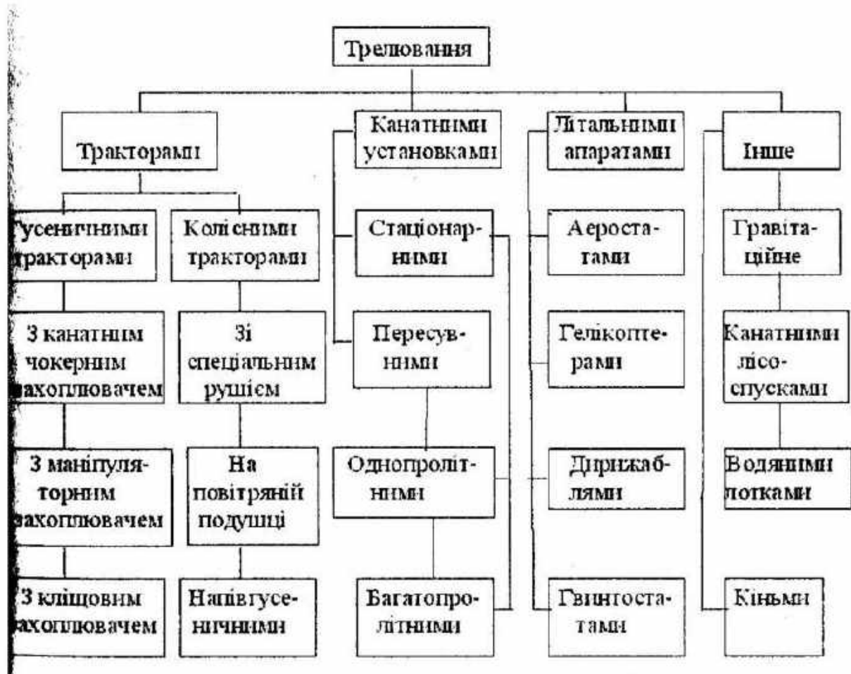
Рисунок 1.1 – Технічні засоби для трелювання деревини
