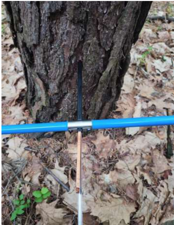
Рис. 2.4 Відбір взірців деревини за допомогою вікового бурава
